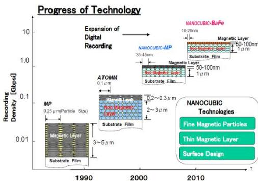
➤ L'oxydation des particules magnétiques est une cause de détérioration des données dans la durée, les particules BaFe étant déjà oxydées, elles ont donc une durée de vie beaucoup plus longue et une stabilité plus importante que les particules métalliques classiques ce qui permet **d'assurer une longévité supérieure des données archivées estimées à plus de 30 ans.**
