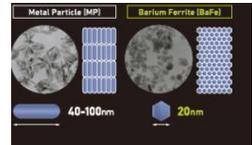
➤ La petite taille des particules BaFe permet également de réduire l'épaisseur de la couche d'enregistrement qui se doit d'être aussi fine que possible afin **d'éviter la création de forces magnétiques inversées qui pourraient corrompre la lecture et l'écriture des données.**
