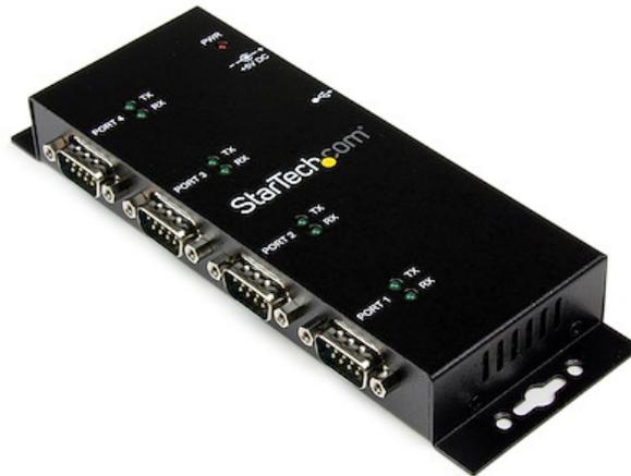
Le hub adaptateur industriel USB vers série 4 ports avec clips de rail DIN ICUSB2324I permet de convertir un port USB en quatre ports série RS232, vous permettant ainsi de connecter, surveiller et contrôler vos périphériques série.
